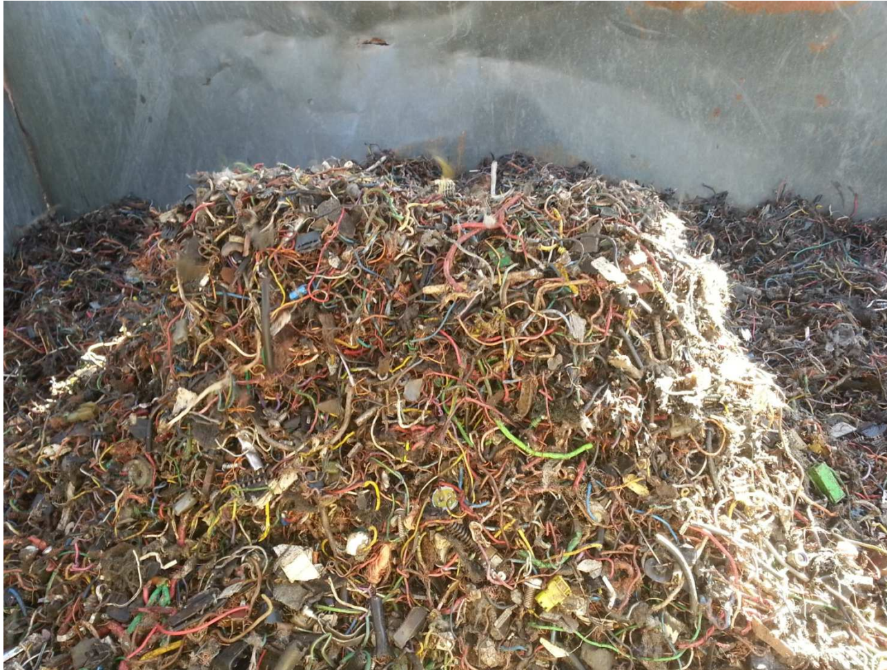
Cavi di rame recuperati attraverso macchina a sensori e selezione manuale.
