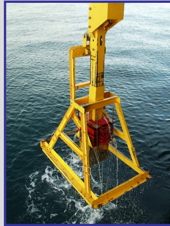
Box-corer interfaccia acqua-sedimento
