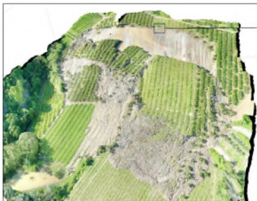
Modello 3D ottenuto con un volo di 20 min
